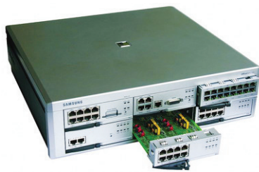
Samsung Office Serv 7200 – решение для сегмента SMB, позволяющее модульно наращивать как емкость, так и функциональность сети
